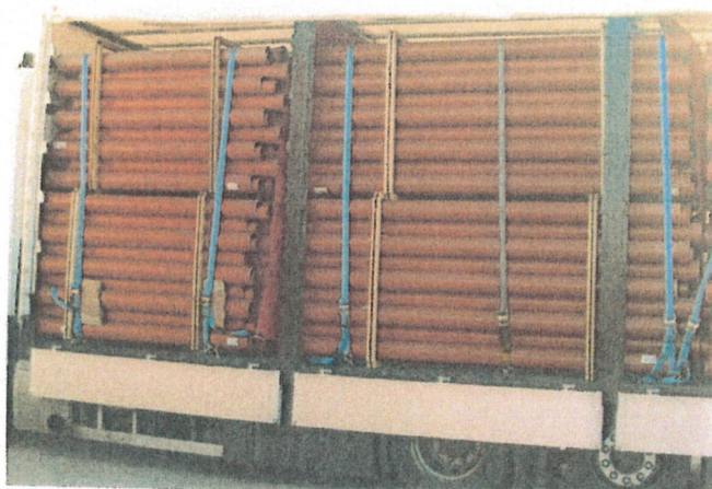
Izgled utovarenog kamiona sa Peštan PVC cevima
